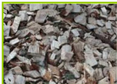
Plaquette forestière calibrée issue de troncs, branches après chantiers d'abattage ou d'entretien
