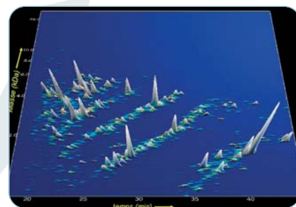
Figure 1 : L'électrophorèse capillaire couplée à la spectrométrie de masse permet de mettre en évidence entre 1500-2000 peptides urinaires par individu. Chaque peptide (pics) est identifié par une masse précise (échelle de gauche) et un temps de migration sur le capillaire (échelle du bas). La hauteur des pics représente l'abondance de chaque peptide dans un échantillon.
